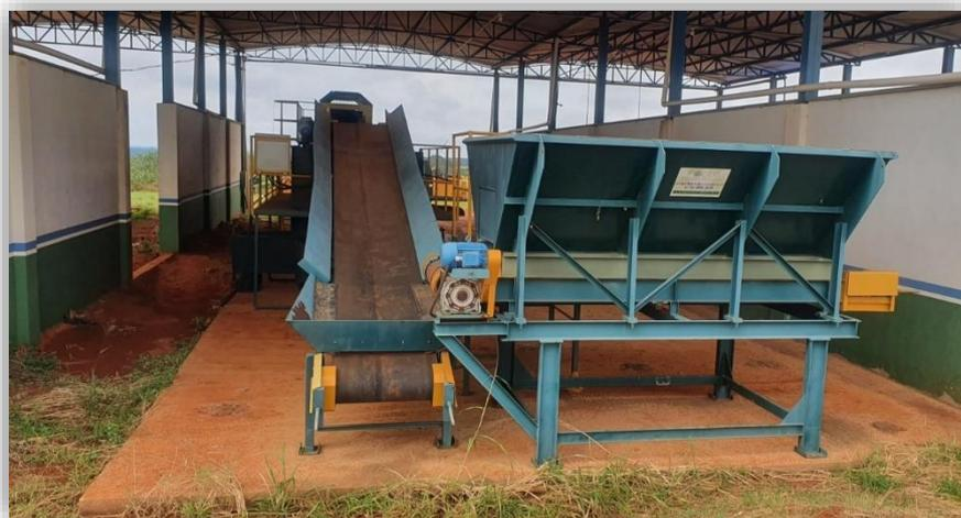
Imagem 88 – Centro de triagem inativo: Esteira para separação e trituração de resíduos sólidos
